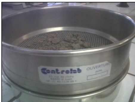
Figure 5 : Passoire à mailles de 2 mm
