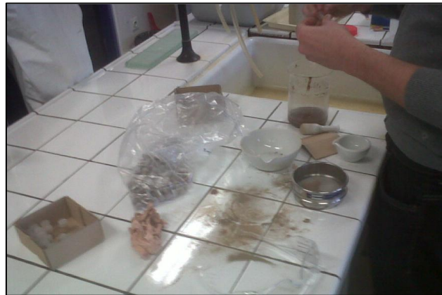
Figure 8 : Réduction des échantillons de sols à un diamètre inférieur à 160 \mu\text{m}
