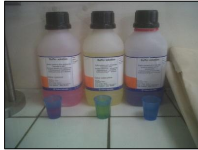
Figure 10 : Solution pH 4, 7 et 10
