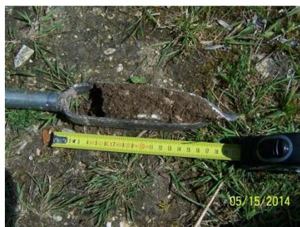
**Figure 6 : Prélèvement des échantillons à l'aide d'une tarière à main**
